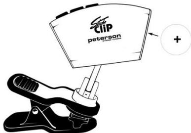
Der SC-1 läuft auf eine CR2032 Knopfzelle Batterie. Um einzubauen, drehen Sie den Tuner so herum damit Sie seine Rückseite ansehen können, entfernen Sie die Batterieaufnahmevorrichtung vom rechten Rand, legen Sie die Batterie in die Aufnahmevorrichtung damit die mit + bezeichnete Seite der Batterie nach oben liegt. Schieben Sie die geladene Aufnahmevorrichtung zurück in den Tuner ein. Eine Batterie symbol erscheint kurz vor die Entleerung der Batterie.
